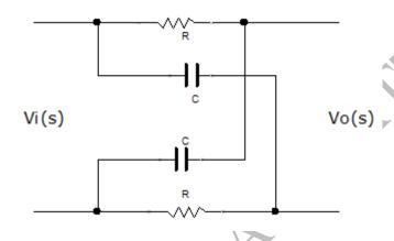
Tali sistemi hanno nella loro funzione di trasferimento una radice a parte reale non negativa. Dopo aver determinato i valori dei poli e degli zeri e scritto l'espressione della funzione di trasferimento, si illustri, mediante una idonea rappresentazione grafica, il comportamento in frequenza del sistema.
