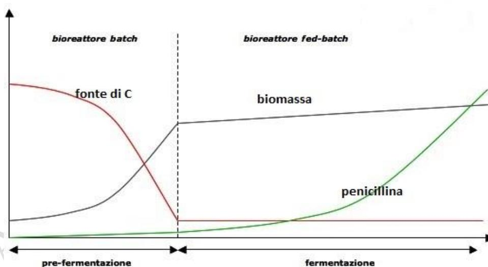
**La figura riporta i profili concentrazione-tempo nel corso della pre-fermentazione e della fermentazione della penicillina.**
